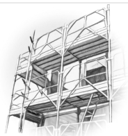
Ponteggio metallico fisso
