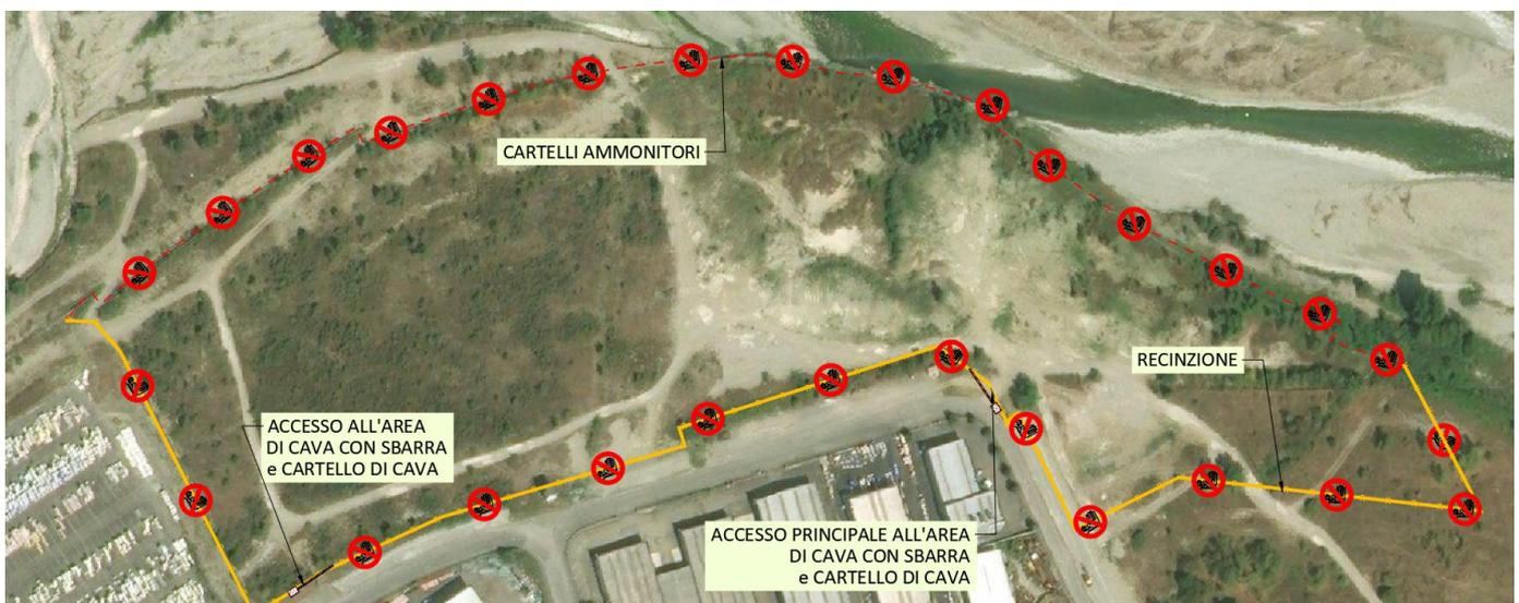
Figura 6. Schematizzazione della recinzione e cartellonistica in progetto
