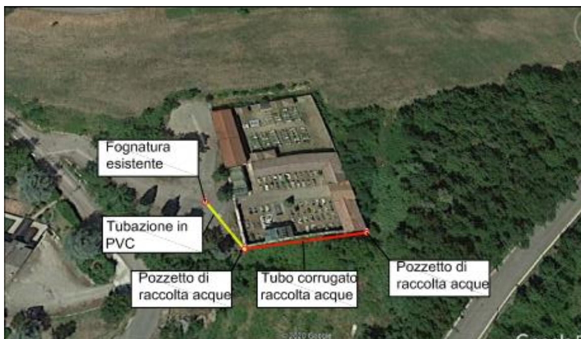
Fig. 11.1- Schema tipo drenaggio acque superficiali
