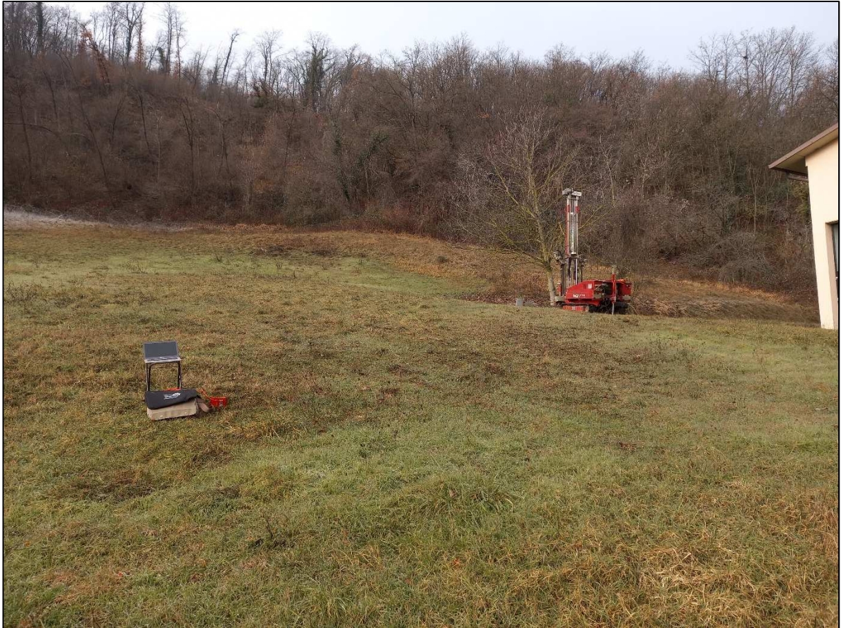
Fig. 4.1- DPSH n°1 e acquisizione HVSr
